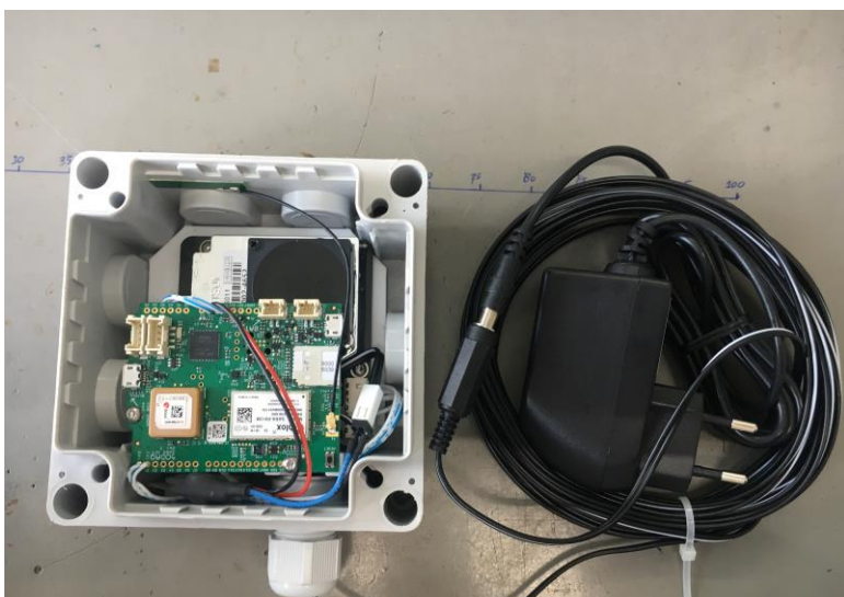
Figuur 1: een foto van de binnenkant van het weerhuisje met SPS30 (boven) en een foto van het kabeldoosje met SDS011 (onder).
